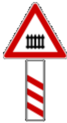
dreistreifige Bake (rechts) vor beschränktem Bahnübergang, 240 m vor dem Bahnübergang
